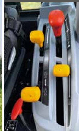
Inschakeling van de achter- en middenaftakas, inclusief de nieuwe eco-aftakasfunctie (hydrostatische versie).
