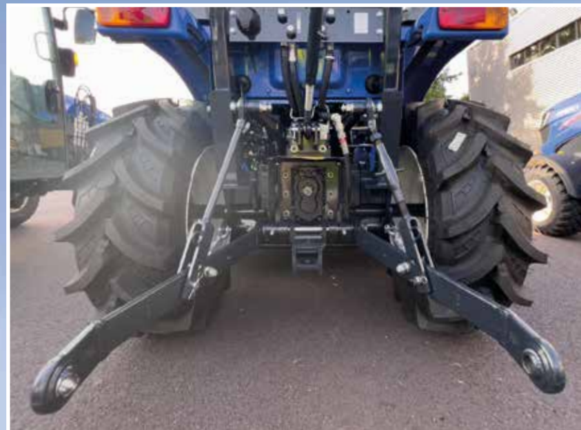
Inschakeling van de achter- en middenaftakas, inclusief de nieuwe eco-aftakasfunctie (hydrostatische versie).
