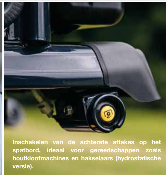
Inschakeling van de achter- en middenaftakas, inclusief de nieuwe eco-aftakasfunctie (hydrostatische versie).
