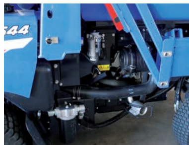
MAKKELIJKE TOEGANG TOT OLIEFILTER, BATTERIJ EN BRANDSTOFFILTER
