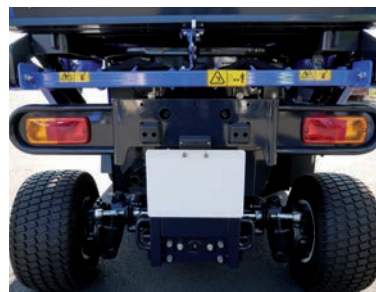
ROBUUSTE ACHTERAS MET GIETIJZEREN HAakse TRANSMISSIE
