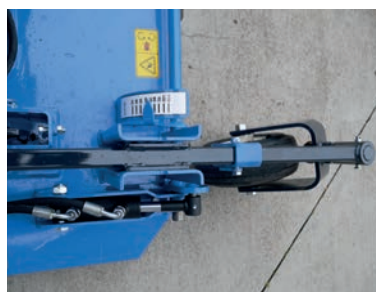
OPTIONEEL KAN DE MAAIHOOGTE OOK HYDRAULISCH VANOP DE BESTUURERSPLAATS WORDEN GEREGLD
