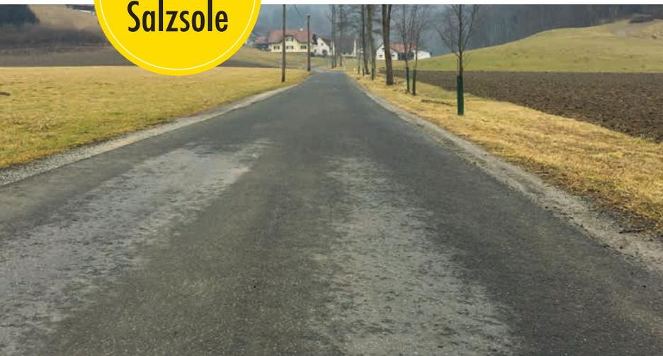
Vorteil Salzsole: keine Salzurückstände, schnelle Auftrocknung
