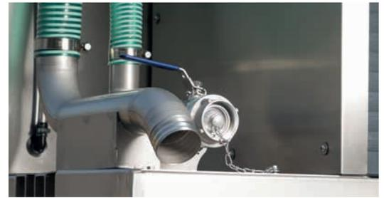
Befüllung C-Anschluss, Überlauf
