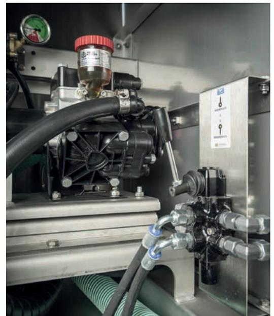
Umschaltventil zwischen Hochdruck- und Solepumpe
