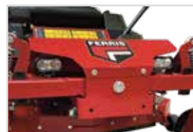
LED lichten - vooraan 2 x 6 watt energie-efficiënte LED lichten vooraan.
