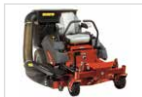
Opvangsysteem Turbo-Pro™ Opvangsysteem van 227 liter met met collector en turbine.
