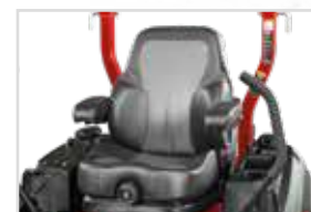
Geveerde stoel met hoge rugleuning Stoel met regelbare vering, gestoffeerde arMLEUNINGEN en vooruit-achteruit regelbaar.
