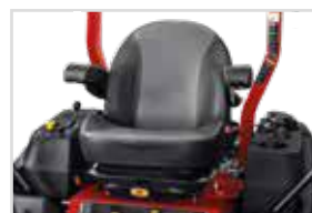
Geveerde stoel met halfhoge rugleuning Stoel met regelbare vering, gestoffeerde arMLEUNINGEN en vooruit-achteruit regelbaar.
