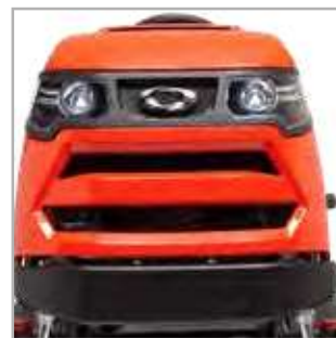
STALEN BUMPER & LED-KOPLAMPEN De stalen bumper voegt extra bescherming toe aan de zitmaaier en de krachtige LED-koplampen verlichten uw rijbaan.
