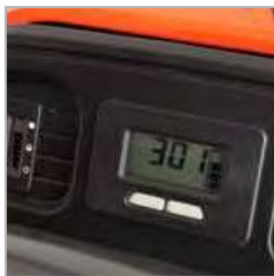
PRAKTISCH BEDIENINGSPANEEL Dit luxe paneel toont wat uw machine nodig heeft. Het bevat een brandstofmeter en een urenteller. De interactieve functie waarschuwt de gebruiker als de machine toe is aan een onderhoudsbeurt.
