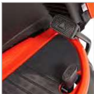
SNELHEIDSCONTROLE Traploos regelbare rijnsnelheid. Pas uw snelheid snel en makkelijk aan.
