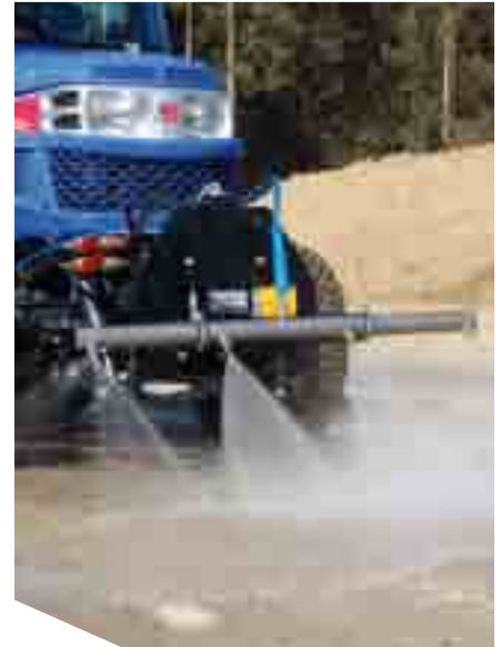
Met de hogedruksproeiboom snel wegen schoonmaken
