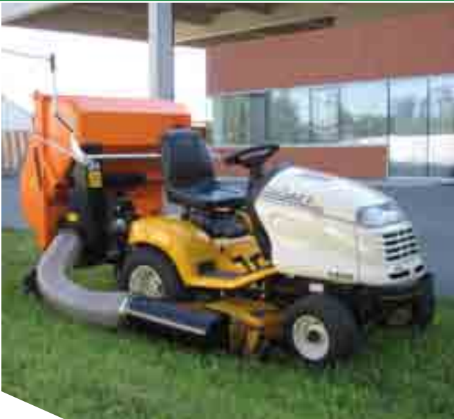
Eigen onafhankelijke aandrijving door verbrandingsmotor
