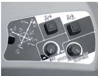
POTENTIOMETERS VOOR DE INSTELLING VAN HET REACTIEVERMOGEN VAN DE TRANSMISSIE EN HET BEPERKEN VAN DE MAXIMALE SNELHEID. DRUKKNOPPEN VOOR HET INSCHAKELLEN VAN DE CRUISE CONTROL OF DE MEMORY CRUISE CONTROL
