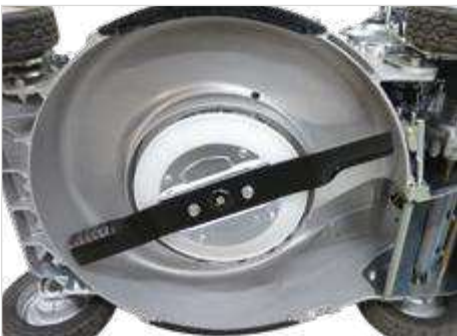
Aluminium maaidek met stalen versteviging
