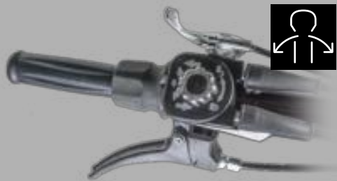
Draaiknop voor traploze snelheidsregeling vooruit en achteruit
