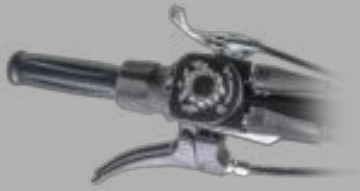
Draaiknop voor traploze snelheidsregeling vooruit en achteruit
