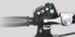
Traploze elektronische snelheidsregeling vooruit en achteruit met Köppel Easy Drive (optioneel). Identieke bediening in vooruit en achteruit (vraagt geen aandacht)
